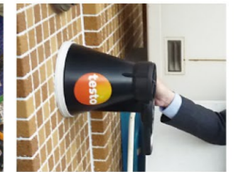
風量測定状況
